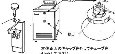
サンプルと外気を隔離させる為、液シール溜に蒸留水を30ml流し込んで下さい。
